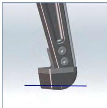
Steigfußbeläge regelmäßig auf Beschädigungen prüfen.
