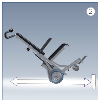
c-max U2 kann bewegt werden. » Bei zu starkem Kippen stoppen die Sicherheitsbremsen den c-max U2 in Vorwärtsrichtung.
