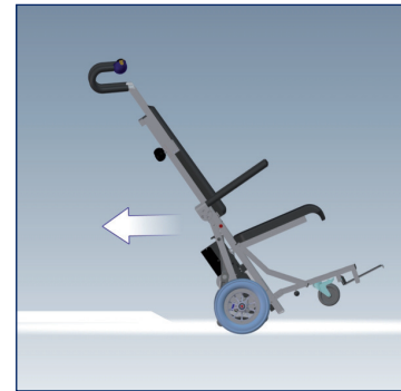
Zum Überwinden von Schwellen mit dem c-max U2 rückwärts an diese heranzufahren und dann über die Schwelle ziehen.
